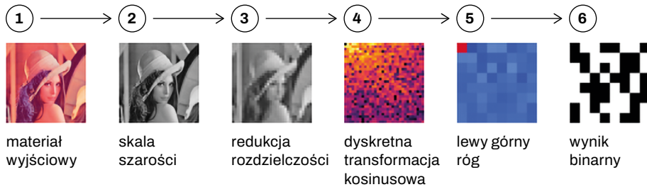
RYSUNEK 5. Schemat przetwarzania obrazu w hash
